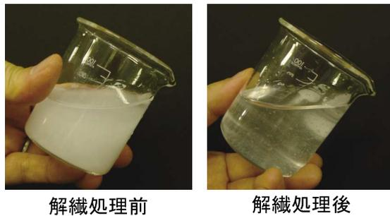
図2 繊維状TEMPO酸化セルロースの水中でのミキサー解繊処理による高粘度透明ゲルの調製
