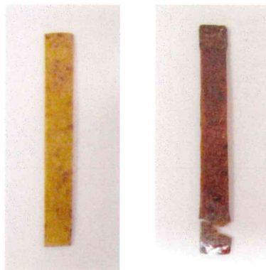
カフェ酸から作製したプラスチックフィルム 左：300°C加熱前 右：300°C加熱後
