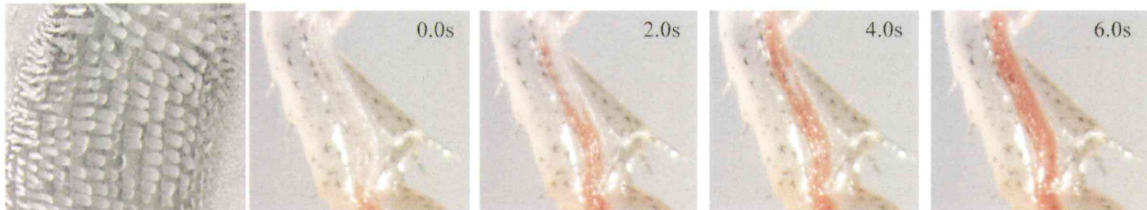
(b) フナムシの構造を模倣した微小流路と水輸送現象
