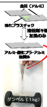
図 酸化プラスチック (PP) と金属 (アルミ)の接着
