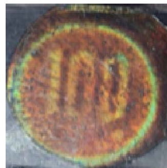
図 植物の主成分から合成した新しいセルロース液晶ゴムによる百円硬貨の凹凸検知。
