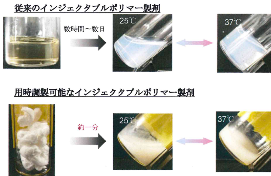
図2 従来のインジェクタブルポリマー製剤と今回開発したインジェクタブルポリマー製剤（PCGA- b -PEG- b -PCGA トリブロック共重合体と PEG の混合物）の比較。左から、乾燥状態，溶液状態，ゲル状態。
