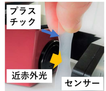
図1 近赤外光による劣化診断の様子
