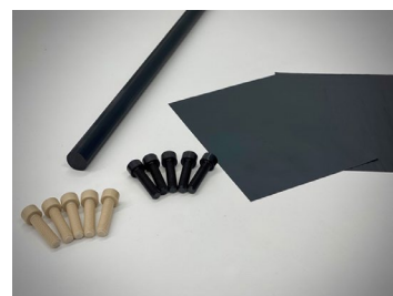
図1 本検討複合材料の成型品（丸棒、ボルト、フィルム）と耐衝撃性試験後のサンプル比較
