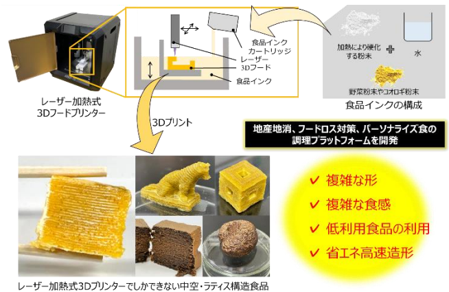
レーザー加熱式3Dプリンターでしかできない中空・ラティス構造食品 図1 レーザー加熱式 3D フードプリンターの開発と様々な調理プラットフォームへの可能性
