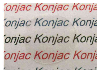
透明性に優れた グルコマンナンエステルの 熱成形フィルム
