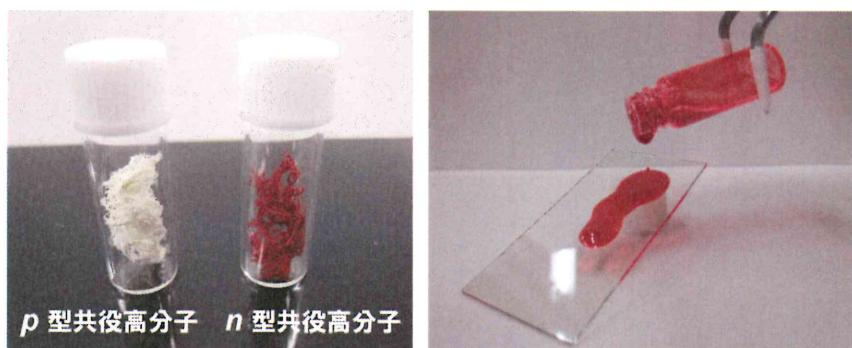
*p* 型、*n* 型共役高分子の溶液を電極に塗ると太陽電池ができる
