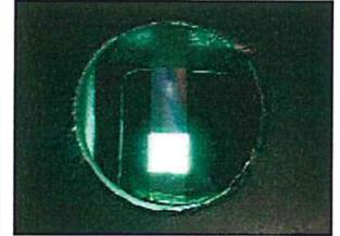
図1 塗布型発光材料によって作られた緑色発光有機 EL 素子
