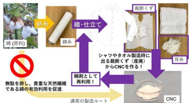
図1 綿生地や糸くずをCNC化し、綿製品製造時に再利用することで、SDGsに叶うモノづくりを推進
