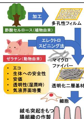
図1 天然由来材料の二層培養基材の構造と立体的な腸組織作製の模式図
