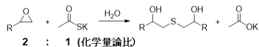
(図A) 2分子のエポキシドと1分子のチオ酢酸カリウムの化学反応式
