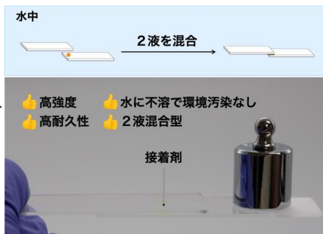
図1 完全水中接着プロセス（上）と水中接着の様子
